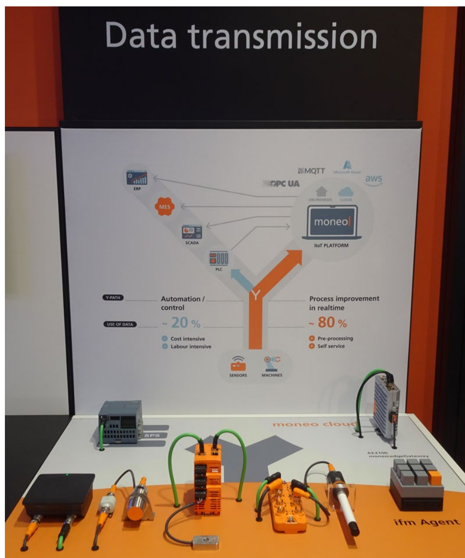
図 4：Y パス（フィールドバスと IoT）、moneo ソフトウェアプラットフォーム、それらと関連する機器・ソフトウェアによるデータ伝送の概念図と展示 出所）ハノーバーメッセ 2025 の ifm electronic 社のブースで筆者撮影。
