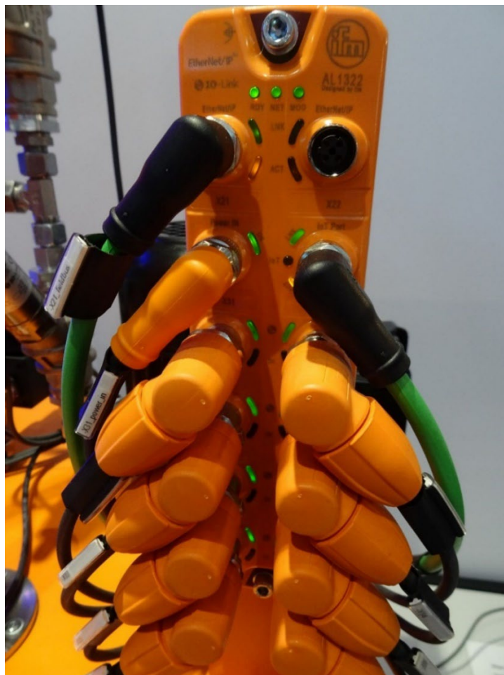
図 2：制御用ポートと IoT ポートがついている ifm electronic 社の IO-Link マスタ
