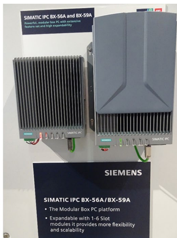
図 5：ハノーバーメッセ 2025 のシーメンス社のブースにおける、大きな情報処理能力を持ち、簡単な拡張性も持つ IPC についての展示
