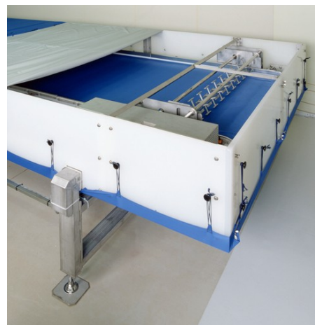
図5 完全無通風自動製麴装置内部
