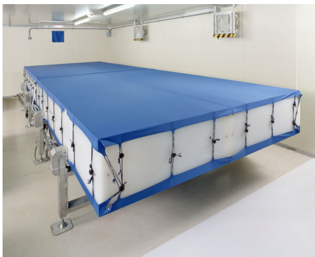
図4 麴室内に設置された完全無通風自動製麴装置
