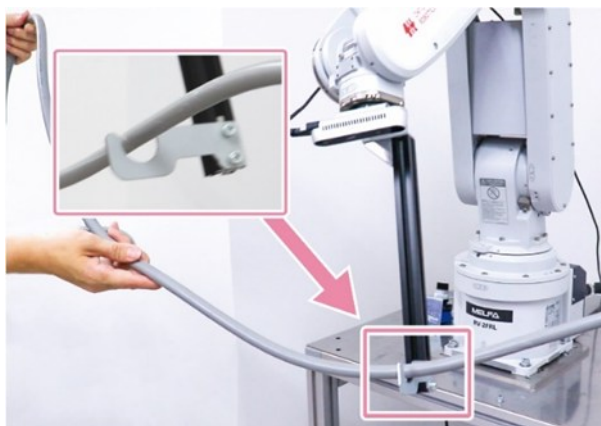
図6 不定形ケーブルのトラッキング作業 (ケーブルの位置姿勢変化も対応可能)
