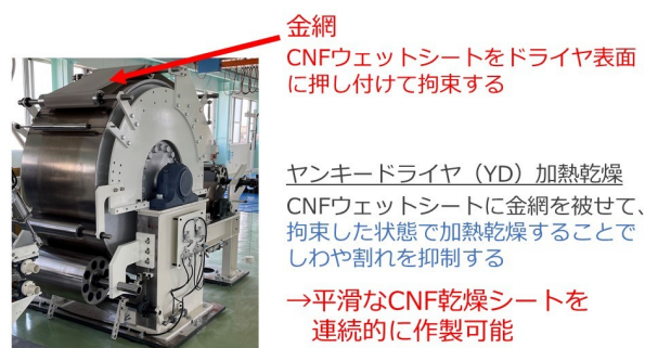
図7 CNFウェットシート乾燥機構
