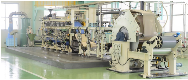
図2 CNF連続シート化装置
