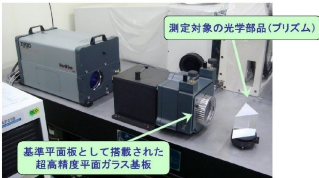
図6 \lambda/100 原器を用いた測定例
