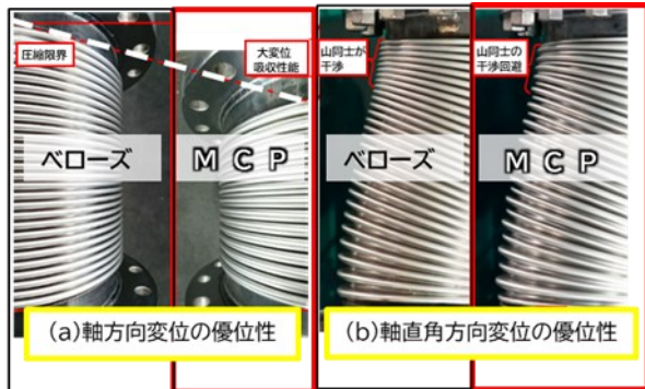
図5 縮小スケール試験体での比較実験
