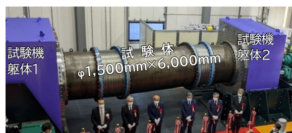
写真2 大変位耐震試験機 (試験体最大サイズφ2,700mm×長さ6,300mm)
