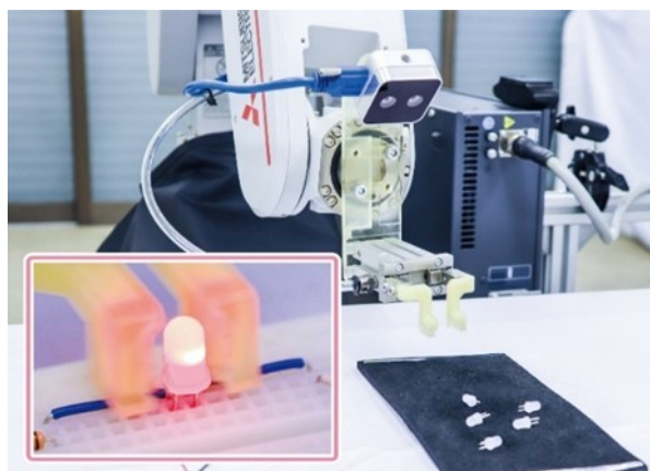
図5 移動式マニピュレータによるLED挿入 (柔軟タイヤ変形の影響下でも可能)
