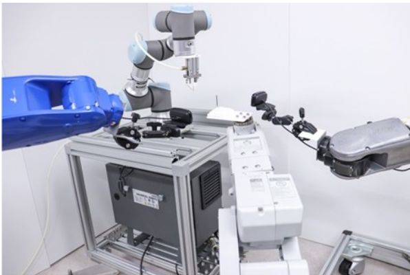
図7 メーカーが異なるロボットアームを位置校正なしで4台協調制御する例
